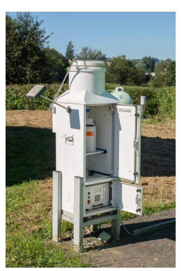
In den Regensammlern wird die nasse Deposition (wässrige Niederschläge wie Regen, Schnee, Hagel und Nebel) aufgefangen um die darin enthaltenen Ablagerungen zu analysieren. Diese Analysen werden unter anderem genutzt um den Status der Versauerung und Eutrophierung der Ökosysteme zu dokumentieren.
