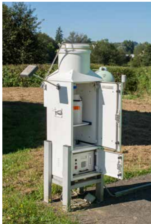
Dispositif de collecte de précipitations de pluie, brouillard, neige ou grêle
